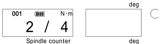
Tighten 1<sup>st</sup> angle of the 2<sup>nd</sup> spindle.
